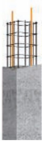
Příklad použití armovaných betonových sloupů / svodového zařízení
