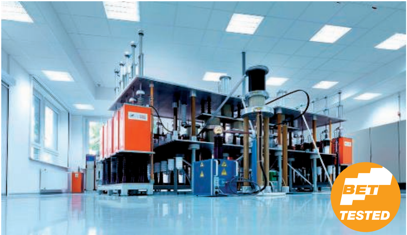
Generátor bleskového proudu a zkušební značka střediska BET
